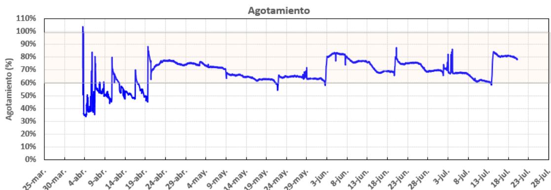
Figura 93. Registro continuo de la humedad volumétrico (v/v) en el suelo de la parcela por medio de sondas.
