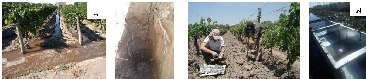
Figura 69. Instrumental de monitoreo de humedad de suelo y caudales de riego. a) método de riego; b) Calicata para instalación de las sondas a distintas profundidades; c) muestreos para determinar contenido gravimétrico de agua; d) Aforador de cresta ancha.
