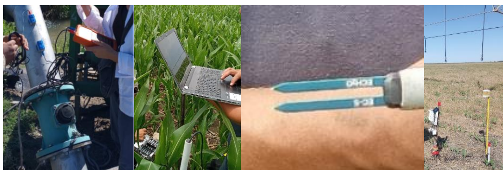
Figura 58. Instrumental de monitoreo de los componentes de riego. Mediciones de caudal del equipo, registro de los datos, y sensores de medición del contenido de agua en el suelo a diferentes profundidades.
