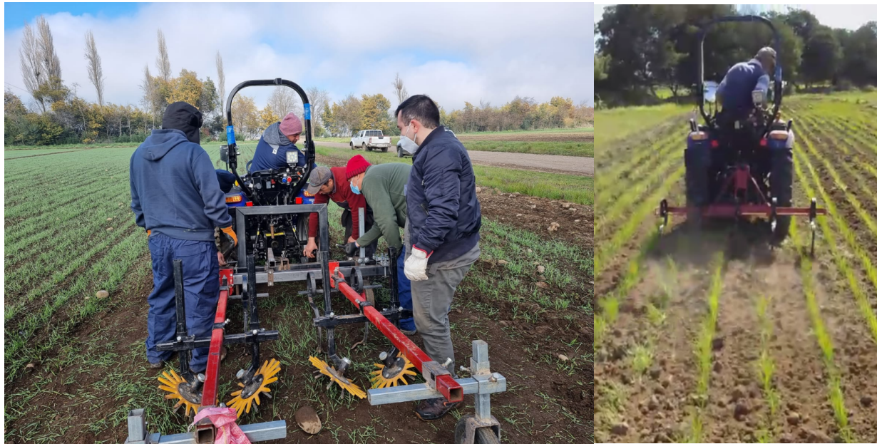
Imagen 1. Prototipos de desmalezadores mecanizados desarrollados para el SICA sin inundación.
